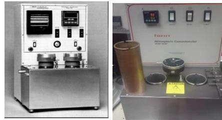
Figura 2. Consistómetro Atmosférico 165 AT
