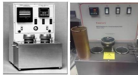
Figura 2. Consistómetro Atmosférico 165 AT
