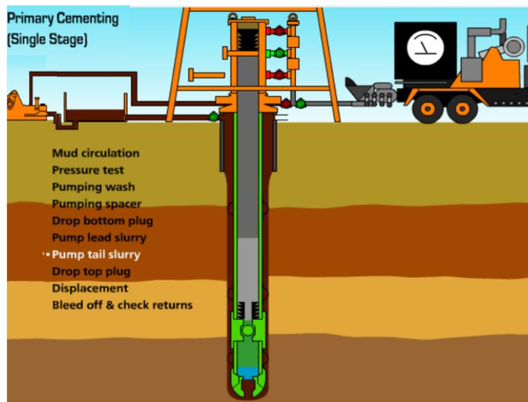
Figura 1. “Cementación de un Pozo Petrolero”.
