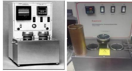
Figura 2. Consistómetro Atmosférico 165 AT
