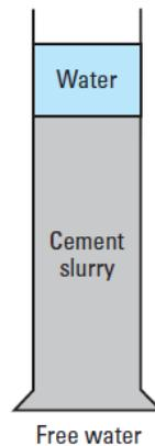
Figura 3. Prueba de Efecto de Agua Libre en una Lechada de cemento antes de fraguar.
