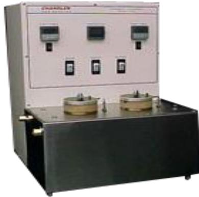
Figura 3. Consistómetro Atmosférico.
