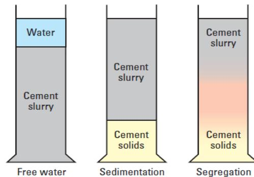
Figura 1. Prueba de Estabilidad en una Lechada de cemento antes de fraguar.
