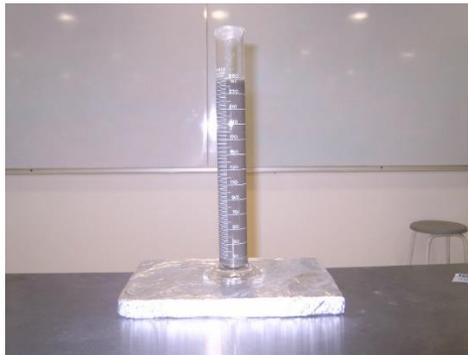
Figura 11. Prueba de Estabilidad en una Lechada de cemento fraguada.
